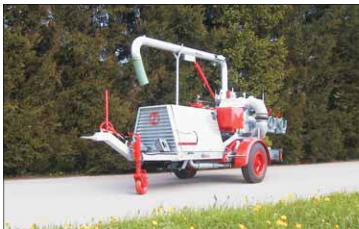
Pumpstation mit Dieselmotor 75PS/56KW
