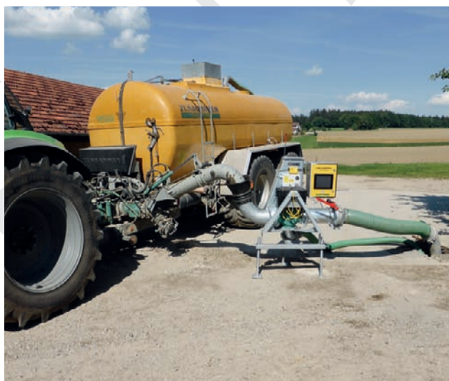
Bilder 4 und 5: Testgespann auf einer Messfahrt mit Trichterstation (links) und mit Schlauchbefüllung (rechts) an den verschiedenen Teststandorten
