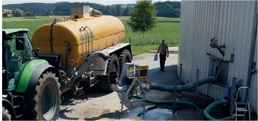
Bild 2: Zunhammer Pumptankwagen „Profi-Tanker“ mit einem Fassungsvermögen von 18.500 Litern und Zunhammer Trista im DLG-Test am Hochbehälter (Foto: Zunhammer)
