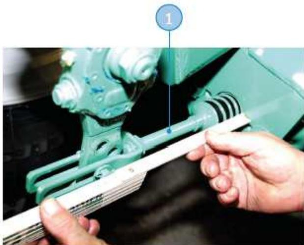
Bild: Hub Kolbenstange
