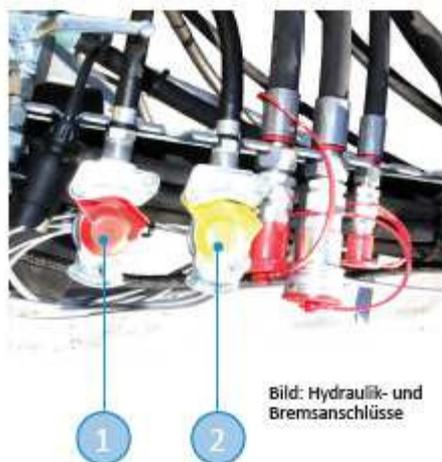
Рисунок: Гидравлические и тормозные соединения
