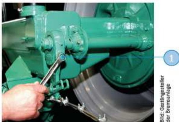
Рисунок: Регулятор зазора тормозных колодок тормозной установки
