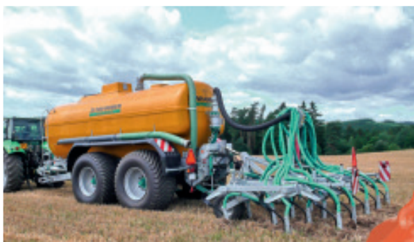
Vibro-Gülle-Grubber mit 4,5m Arbeitsbreite
