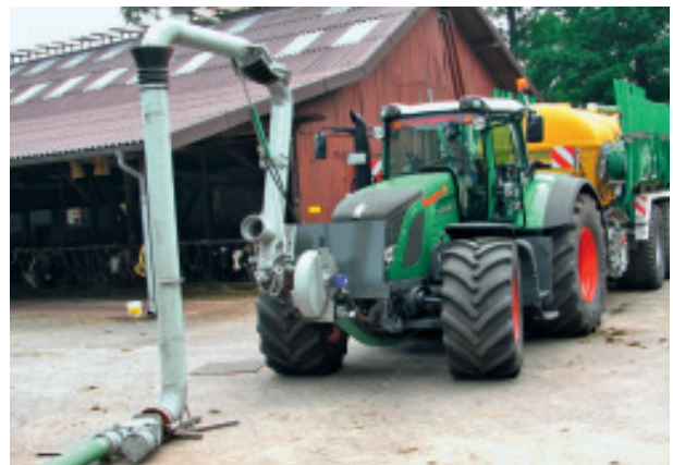
Frontandocksystem an der Güllegrube
