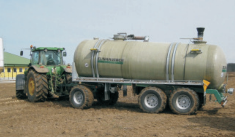
K21T - Transportanhänger mit Pumpanlage
