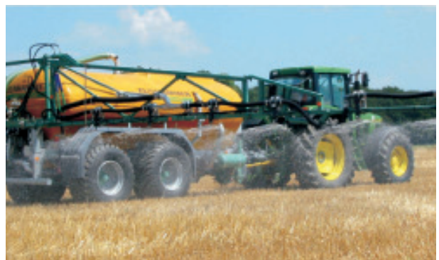
Spezial-Tanker K11PUL für Vinasse oder Flüssigdünger
