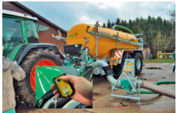
Trichterstation mit Funk/Fernbedienung
