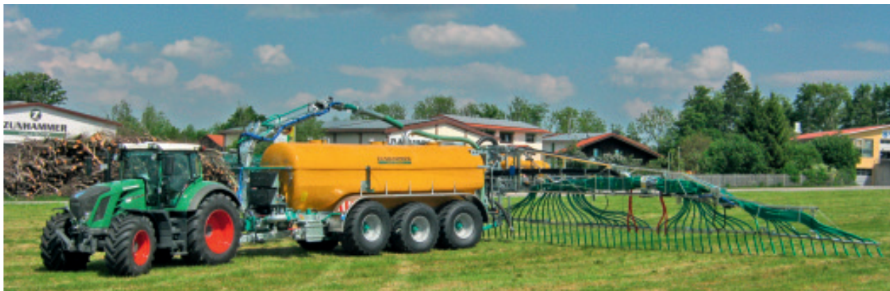
SKE 24000PU TRIDEM mit 27m Schleppschauchverteiler
