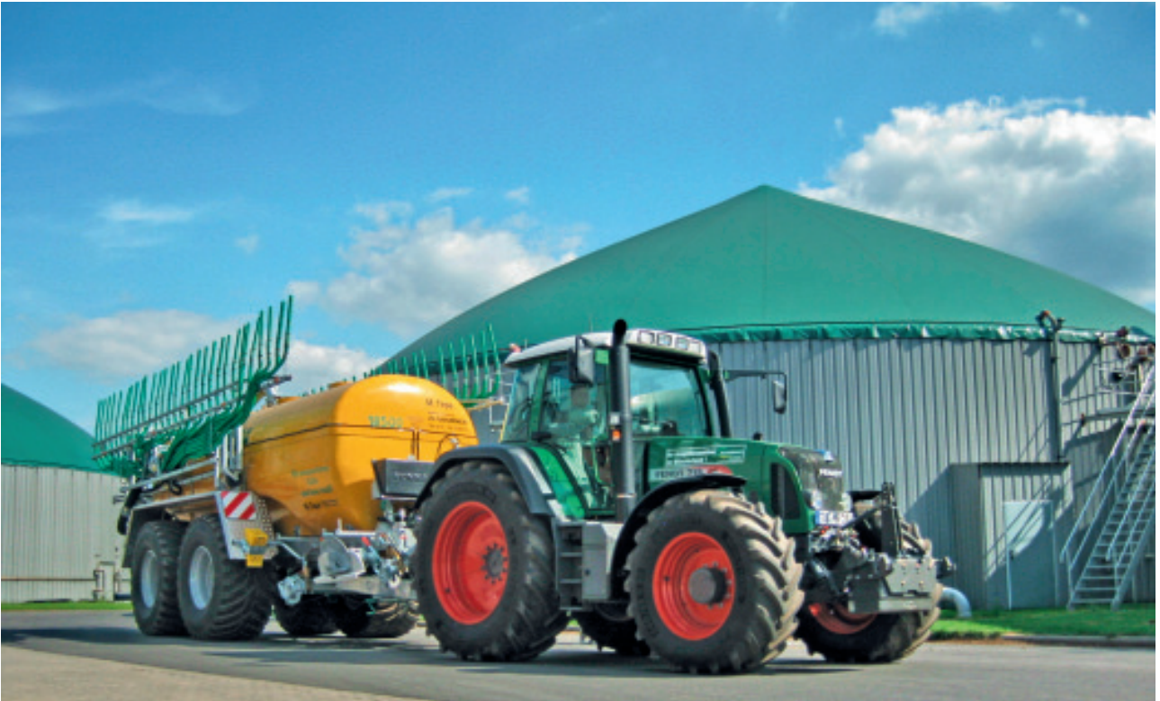
SK18500PU mit 15m Schleppschlauch in Transportstellung
