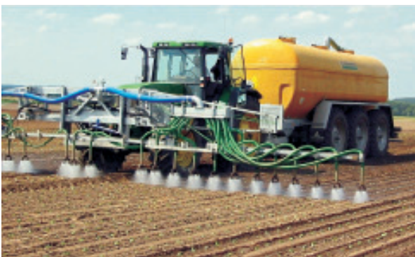
Spezial-Wassertanker SK27PU mit Verteilbalken für Gemüsebau
