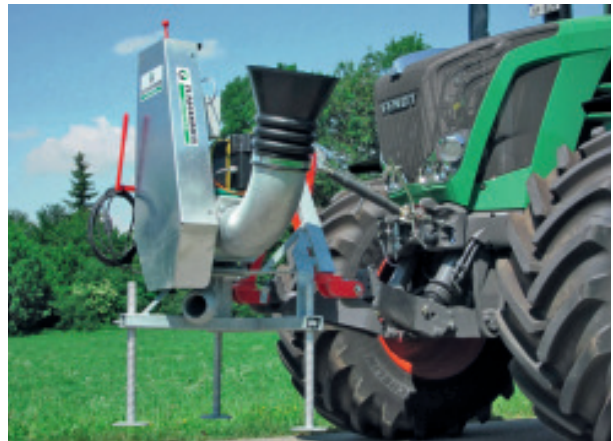
Trichterstation Funk beim Transport
