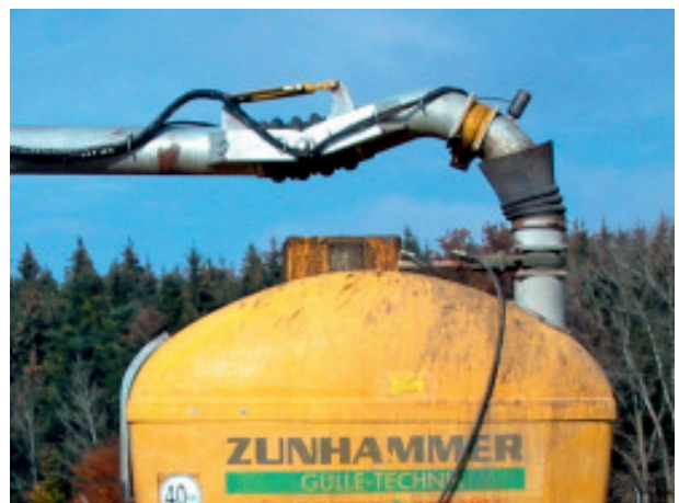
Extremneigung des Elastiktrichters beim Übertanken
