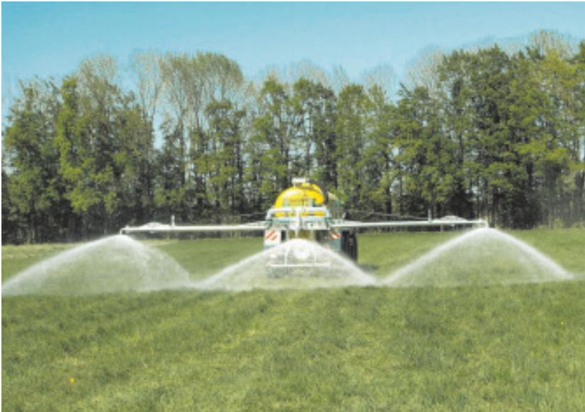
Düsenbalkenverteiler im Einsatz
