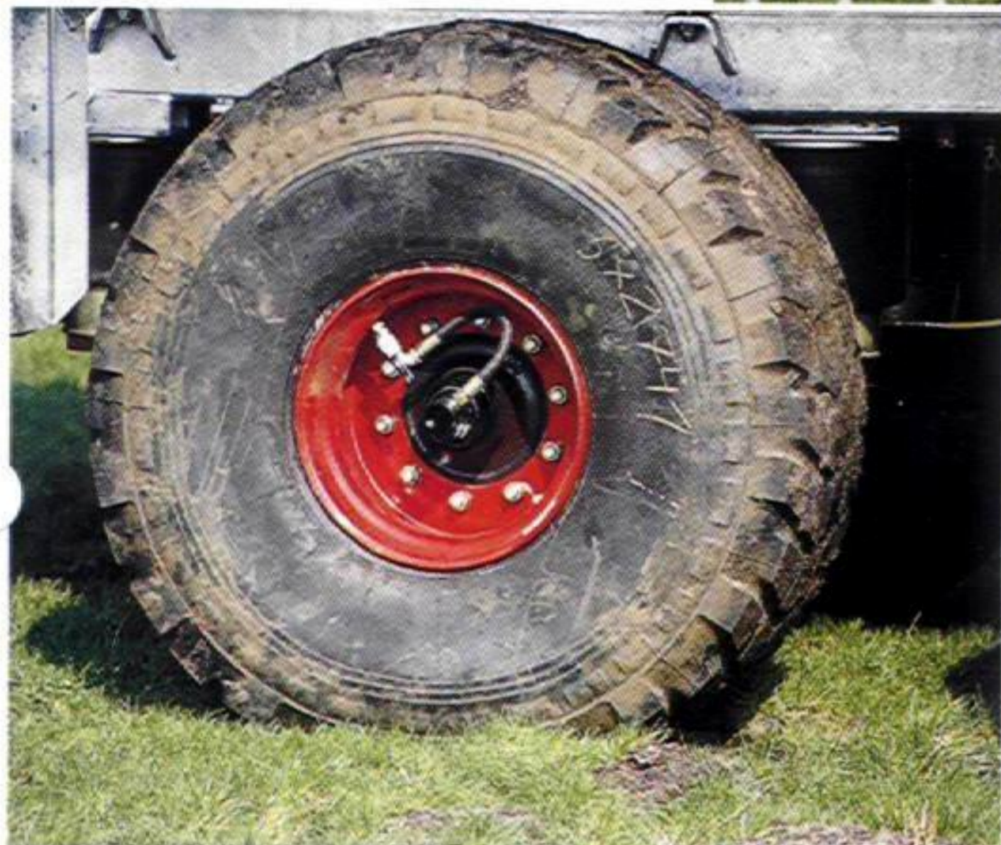
Mit Hilfe von Reifendruck-Regelanlagen lässt sich der Bodendruck deutlich senken.
