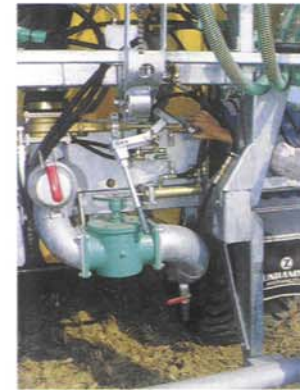
Per Schlauch können Fremdkörper abgelassen werden (links). Das klappt meist gut. Verstelldrosseln vom Gestänge (rechts).
