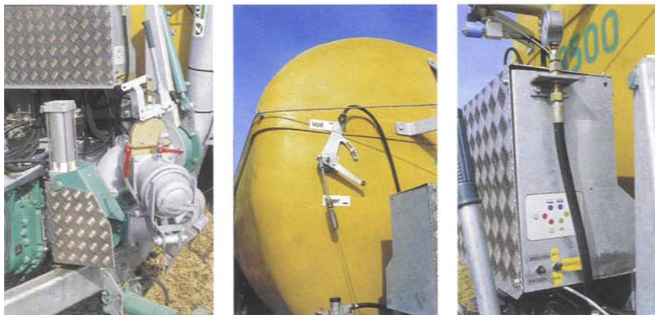
Ein pneumatischer Zylinder, der von der Druckluftanlage des Traktors versorgt wird, betätigt den Dreiwegehahn im Saugbereich der Pumpe. Beim Absenken vom Saugarm öffnet er. Sobald die Füllstandsanzeige „voll“ meldet, schließt er automatisch.
