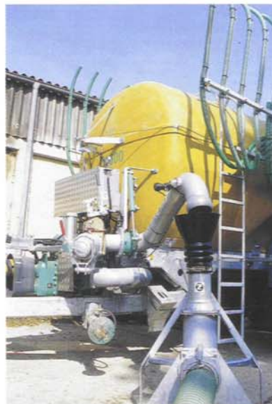
Der Vollgummi-Trichter an der Saugstation ist praktisch verschleißfrei. Man muss aber exakt heranfahren.
