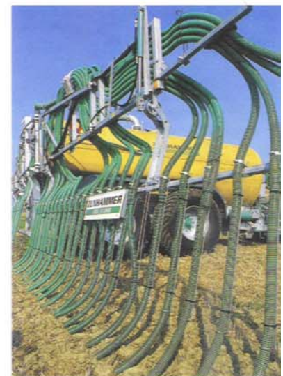
Die Exacut-Verteiler laufen inzwischen zuverlässig. Durch Heben vom Schleppschlauch wechselt die Drehrichtung.
