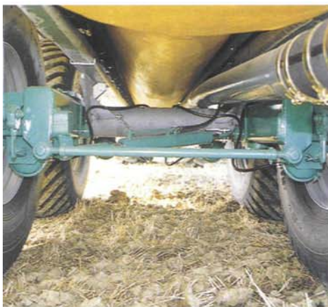
Gut: Diagonal sind zwei einfachwirkende Zylinder aneinandergesetzt, die die Lenkachse bei Bedarf sperren.
