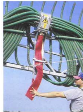
Per Schlauch können Fremdkörper abgelassen werden (links). Das klappt meist gut. Verstelldrosseln vom Gestänge (rechts).
