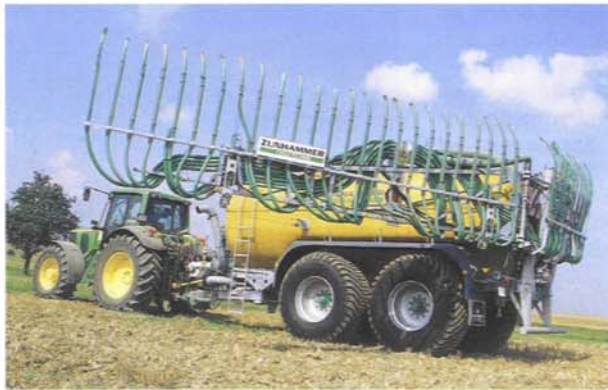
Erst das Gestänge ausklappen. Mit dem Absenken der Schläuche öffnet der Hauptschieber und die Verteiler laufen an.
